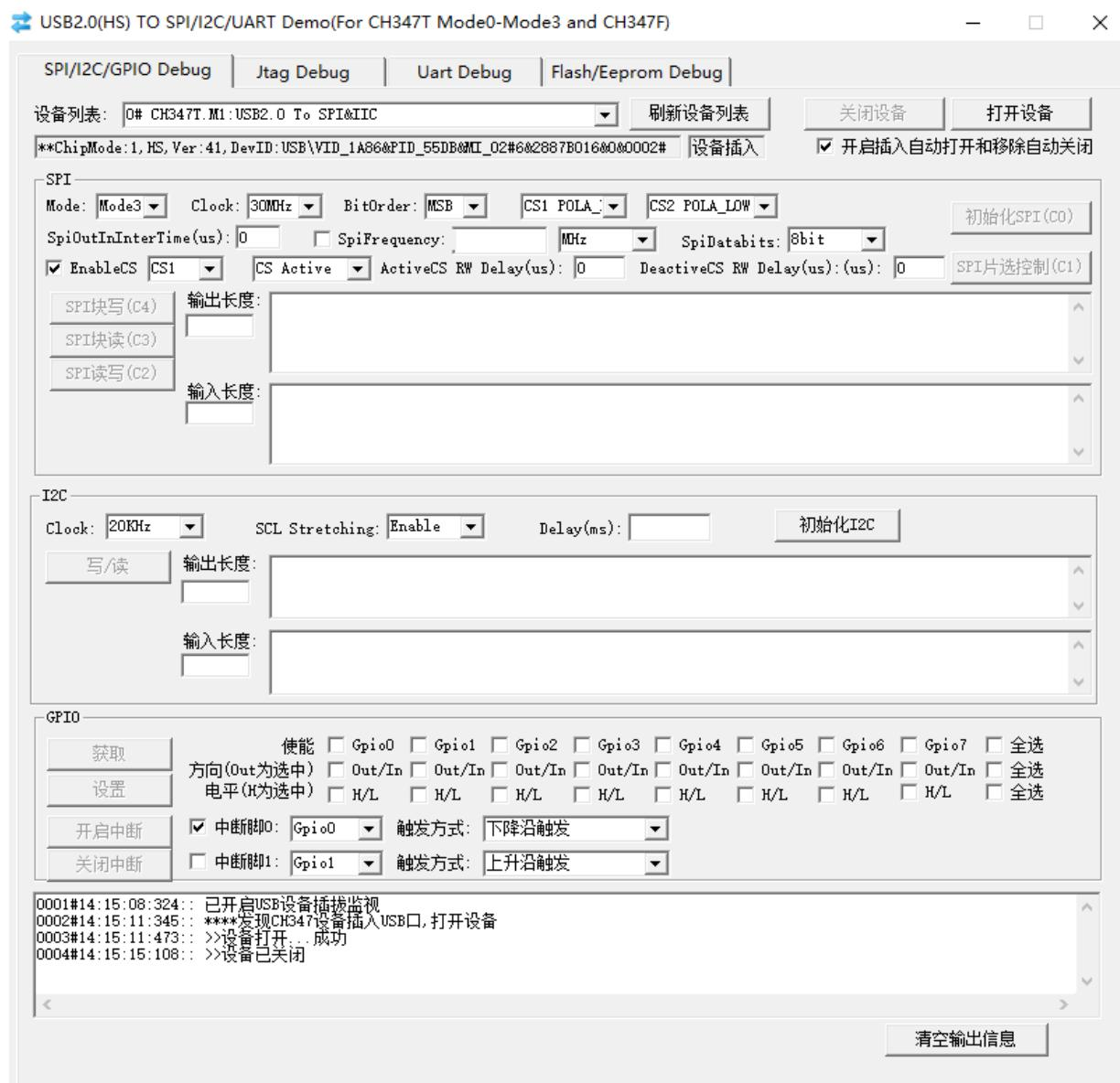
CH347F 和 CH347T 的 I2C 同步串口完全兼容 I2C 总线时序, 可以支持各种符合该时序的 I2C 器件, 例如 A/D 和 D/A 芯片、I/O 扩展芯片、串行存储器以及 IC 卡等, 支持多个器件共享总线。一般
